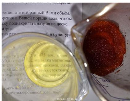
Рисунок 5. Полиакрилатный гель, полученный из золя наносеребра
