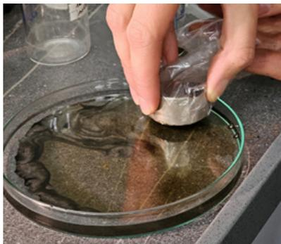
Рисунок 13. Сбор нефти наночастицами магнетит@ОК (олеиновая кислота)
